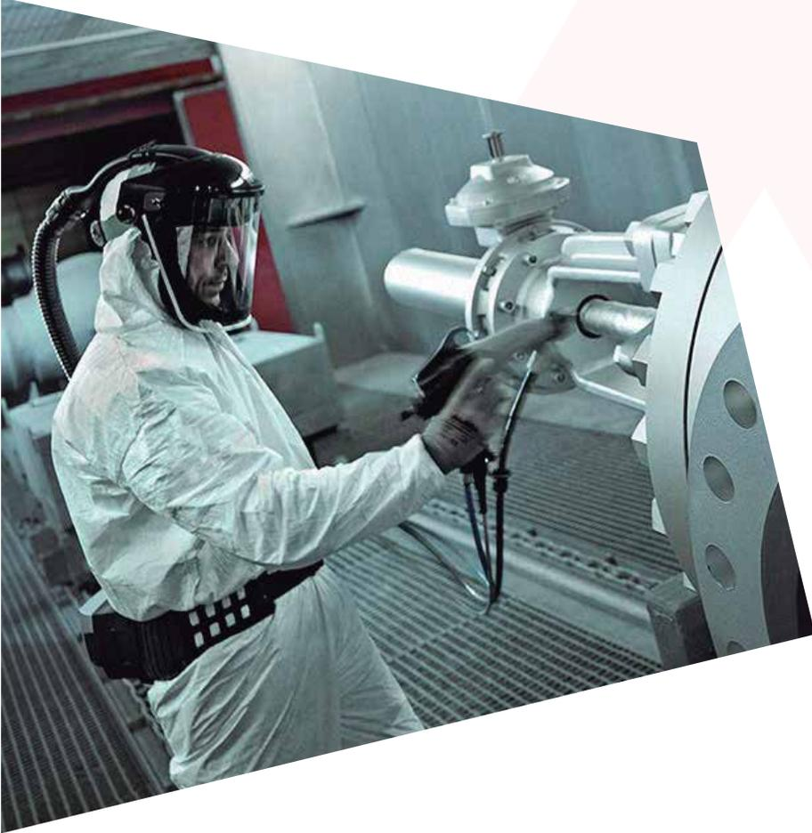
La primera barrera para proteger el metal contra la corrosión externa, es la aplicación de un recubrimiento que protege o aísla la superficie metálica del electrolito en el cual se encuentra embebida.
